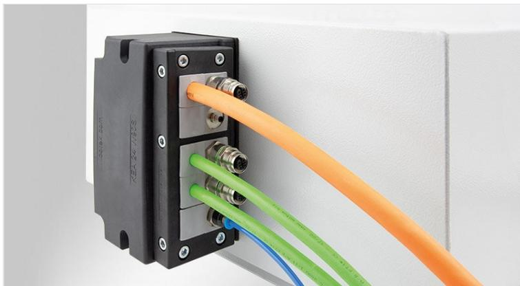
KEA 24 est un adaptateur destiné à accueillir diverses entrées de câble icotek de taille 24. L'adaptateur permet d'insérer des câbles à un angle de 90°. Le sens d'installation peut être horizontal ou vertical. Les câbles sont mécaniquement protégés en entrée et en sortie. Le montage mural se fait soit par vissage avec vis et écrou, soit à l'aide de douilles filetées. Un joint mural approprié est inclus dans la livraison. icotek propose également des poinçons adaptés à la découpe.
